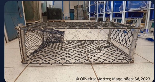
Figure 1. L'éco-piège avec ses dispositifs d'exclusion des langoustes et poissons, ainsi que le dispositif anti-pêche fantôme (AGFD), qui utilise des ficelles en coton ou en sisal fixées à la barre d'armature en fer
