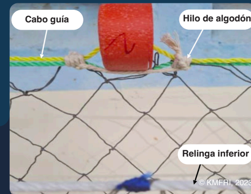
Figura 1. Utilización de hilos de algodón en lugar de hilos sintéticos no degradables para unir el cabo guía de una red de enmalle con los paneles de red
